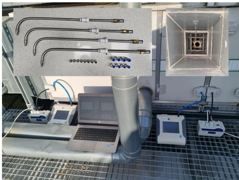
Zadanie 1.ZS.02. Stanowisko badawcze w warunkach użytkowania central wentylacyjnych budynku
