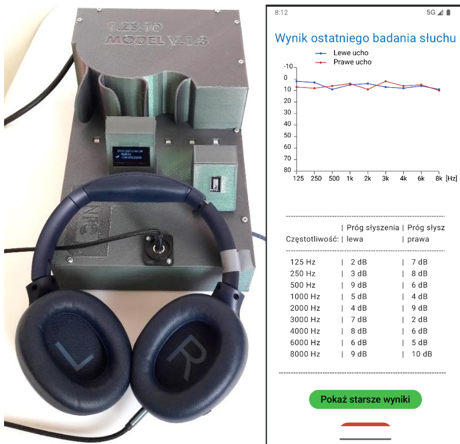
Zadanie 1.ZS.10. Wersja końcowa modelu opracowanego urządzenia (po lewej stronie) oraz zrzut ekranu wyników badań opracowanej aplikacji mobilnej
